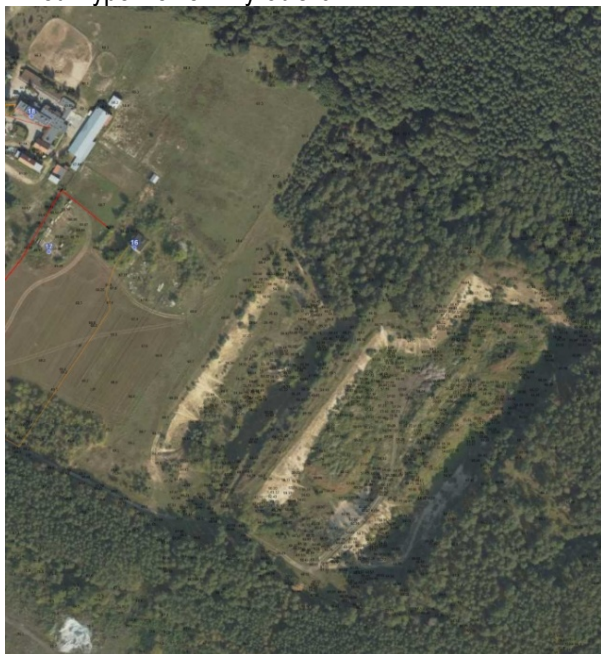
Rysunek nr 4.7-3 Efekty przeprowadzonych działań rekultywacyjnych działki nr 111 (stan przed i po wypełnieniu wyrobiska)
